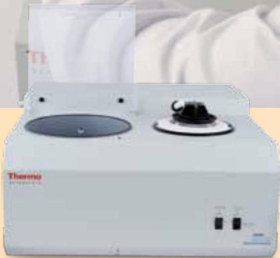
El kit SpeedVac ISS110 P1 incluye una trampa de frío integrada, bomba, rotor de 64 x 1,5 ml y un frasco de 1 litro de líquido de transferencia de calor Thermo Scientific CryoCool
