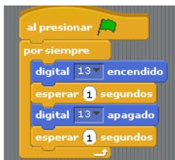
Figura 1. Hacer titilar un led con S4A con bloques
