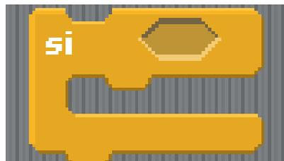
Este bloque nos permite evaluar una condición(que será el bloque que va a dentro del hueco que se ve) si se cumple se ejecuta lo que este dentro del bloque
