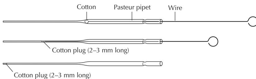
**FIGURE 5.9** Preparing a Pasteur filter-tip pipet.
